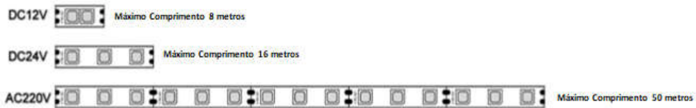
Figura ilustrativa da capacidade máxima de seções contínuas com fitas de LED em correntes diferentes
